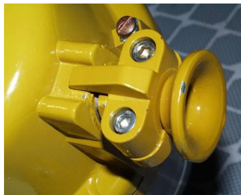
Rögzítő bilincs (tömítő gumi gyűrűtől függetlenül szorítva)
