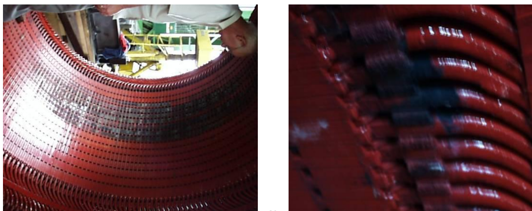
6. ábra A rotor beverődött a statorba. A stator vezetői zárlatosak.
