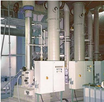
*Bypass-Anlage zur Rückgewinnung von Salzsäure aus Rauchgas*
